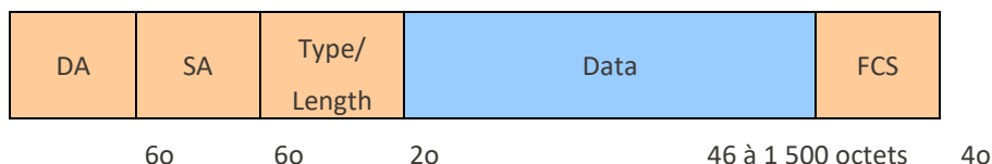
Figure 5 - Format trame Ethernet 2 et 802.3
